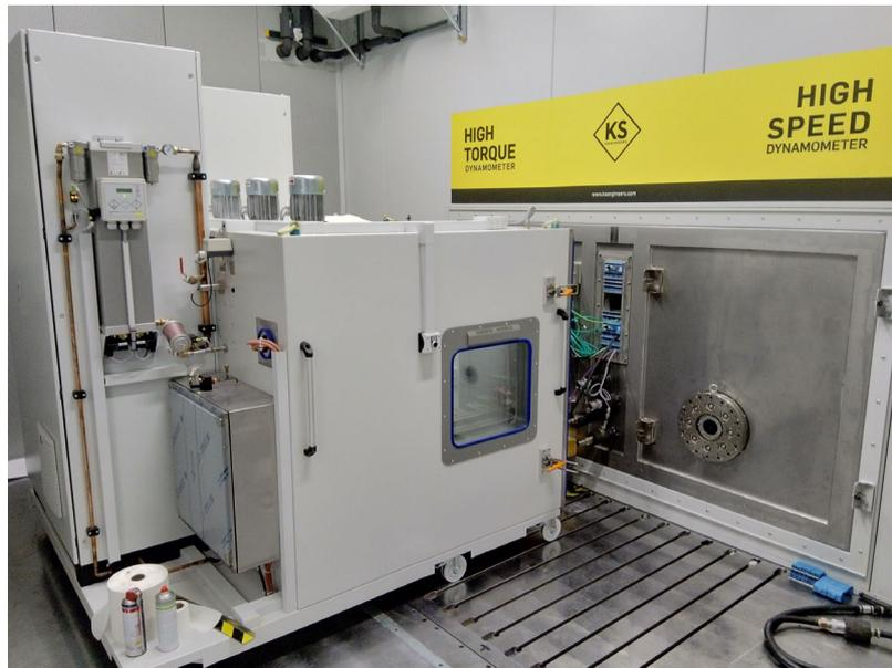
Abbildung 3.5: P5-Akustikkammer mit Luftkonditionierer für High-Torque- und High-Speed-Prüflinge
