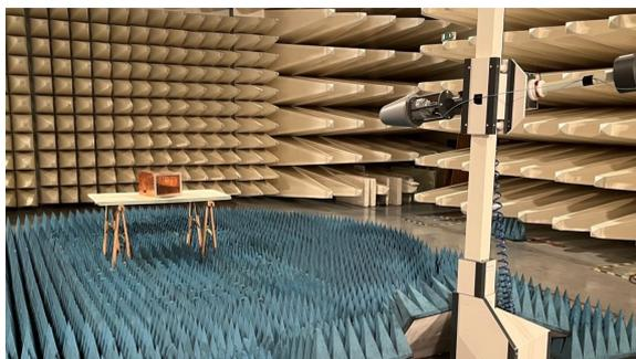
(a) Messaufbau und Prüfling in der Absorberhalle
