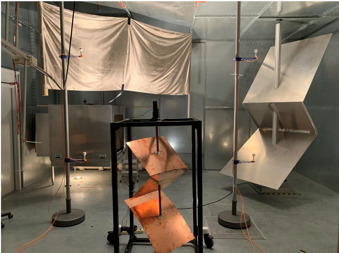
Abbildung 3.27: Modenverwirbelungskammer in Magdeburg mit einem leitfähigen Textil (oben links), einem kleinen, schnellrotierenden Modenrührer (mittig) und einem großen, langsamrotierenden Modenrührer (rechts)
