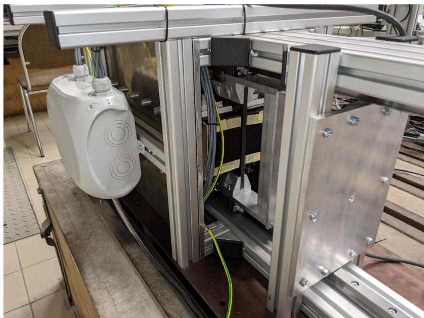
Abbildung 3.17: Prototyp der Linearmaschine
