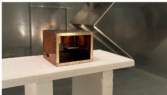
(b) Messaufbau und Prüfling in der Modenverwirbelungskammer
